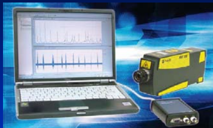
3PDV-100plus Polytec con interferometro di Mach Zender
